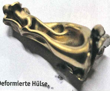
Patrone explodiert vorzeitig, Hülsenrest steckt im Lager.
